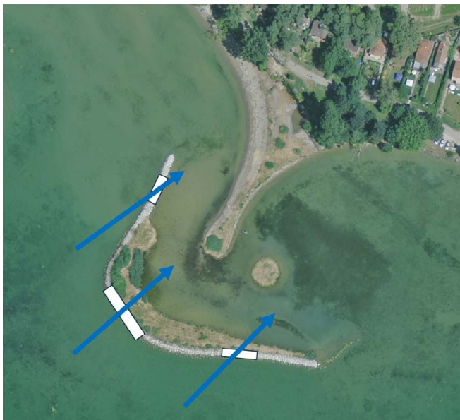
Figure 10: Two possible solutions: Three openings in the riprap embankment [left] and removal of the western section of the dike to achieve a B/S ratio of 1. Abbildung 10: Zwei Lösungsansätze: Drei Öffnungen in der Steinschüttung [links] und Entfernung des westlichen Deichabschnitts, um ein Verhältnis B/S = 1 zu erreichen.
