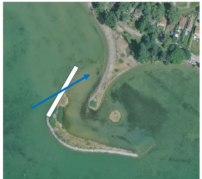
Figure 10: Two possible solutions: Three openings in the riprap embankment [left] and removal of the western section of the dike to achieve a B/S ratio of 1. Abbildung 10: Zwei Lösungsansätze: Drei Öffnungen in der Steinschüttung [links] und Entfernung des westlichen Deichabschnitts, um ein Verhältnis B/S = 1 zu erreichen.
