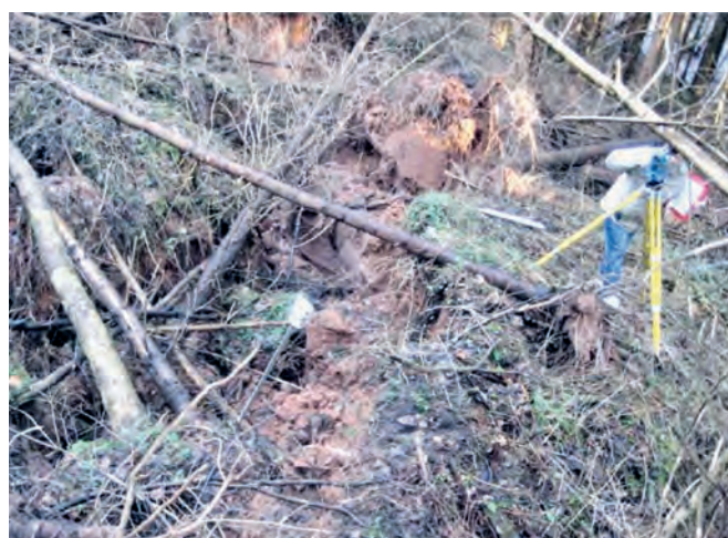
Abbildung 5: Tachymetrische Aufnahme der Erosionsschäden Figure 5 : Relevé tachymétrique des dégâts d'érosion
