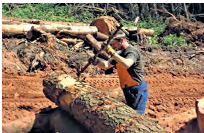
Abbildung 10: Einkerbn der Hölzer Figure 10 : Entaillage des bois
