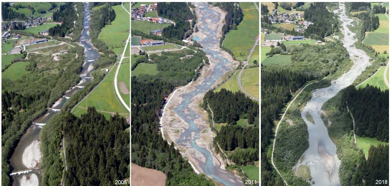
Abbildung 3: Der Mareiter Bach bei Stange, vor [2005] und nach [2011, 2018] Umsetzung der Revitalisierungsmaßnahmen:
