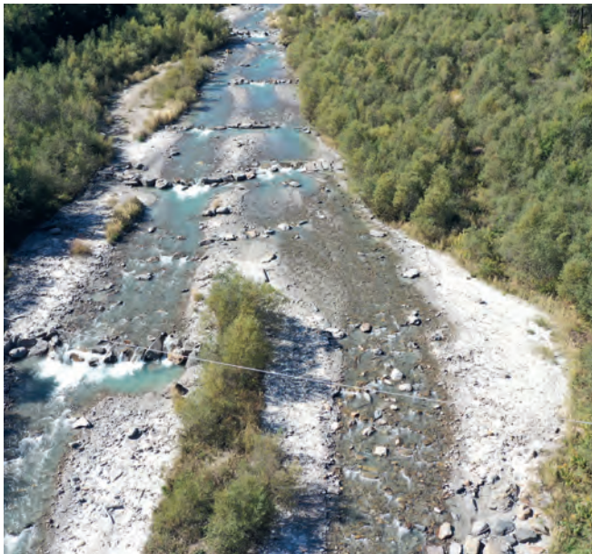
Abbildung 7: Foto mit Drone [REVITAL 2022] im oberen steileren Abschnitt mit ausgewaschenen Querbauwerken [links] und Auflandungen im unteren flacheren Abschnitt im Bereich der Gewerbezone [rechts].
