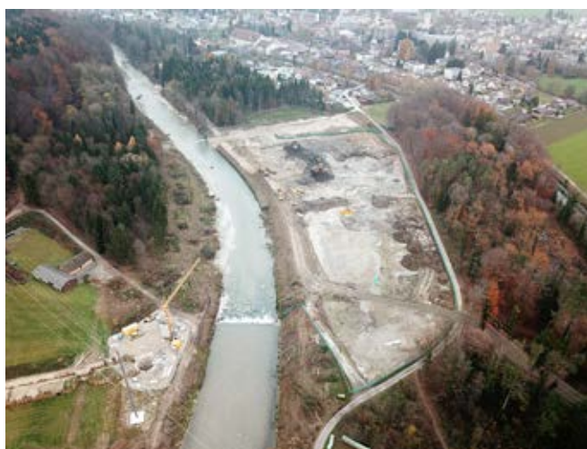
Abbildung 1: Kehrichtdeponie Schwarzweg während der Sanierung 2016/17 [Aushub 90'000 m 3 , links, Foto: AfU Kt. SO] und im Mai 2021 [rechts; Foto: IUB Engineering AG].
