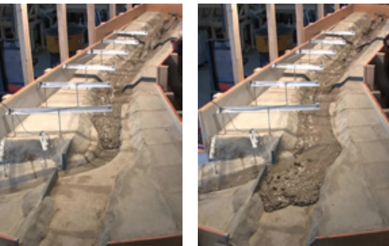
Abbildung 5: Murgangereignis im Illgraben-Modell, links kurz vor und rechts während der Pfywald Ausleitung. Ein Teil des Abflusses fließt durch das Dosierbauwerk im Gerinne weiter, der andere Teil wird über die Ausleitung in den Pfywald geführt. Blick gegen Fließrichtung. | Figure 5 : Événement de lave torrentielle dans le modèle de l'Illgraben, gauche peu avant et droite pendant la dérivation. Une partie de la coulée continue de s'écouler à travers l'ouvrage de dosage dans le canal, l'autre partie est conduite via la dérivation dans le Pfywald. Vue dans le sens contraire de l'écoulement.
