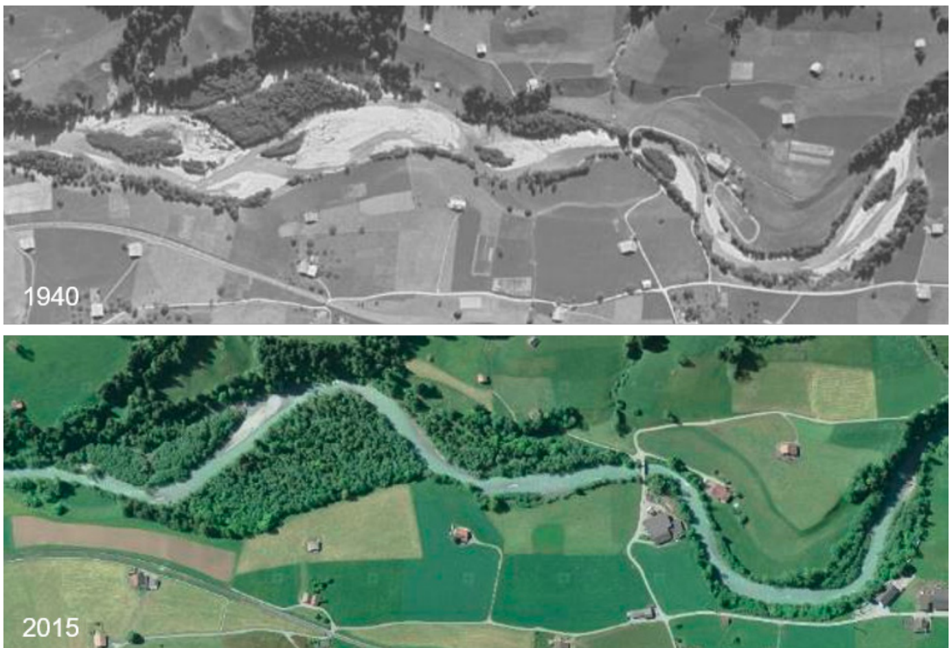
Abbildung 5: Morphologische Veränderungen aufgrund von Kiesentnahmen an der Simme zwischen 1940 und 2015. Die Geschiebefracht reduzierte sich von 12'000 m 3 /a auf 6'000 m 3 /a, die Breite von 52 m auf 33 m und die Gerinneform wechselte von verzweigt auf ein gewundenes Einzelgerinne. Daten: Schälchli und Hunzinger [2021]. Luftbilder: Swisstopo. | Figure 5 : Modifications morphologiques dues à l'extraction de gravier sur la Simme entre 1940 et 2015. Le charriage a été réduit de 12'000 m 3 /a à 6'000 m 3 /a, la largeur de 52 m à 33 m et la forme du lit est passée d'un chenal ramifié à un chenal unique sinueux. Données : Schälchli et Hunzinger [2021]. Photographies aériennes : Swisstopo.
