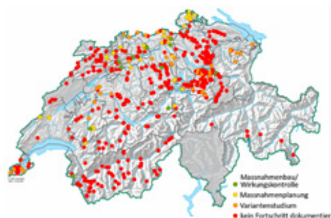
Abbildung 9: Umsetzungsstand der Geschiebesanierung Ende 2018. Jeder Punkt repräsentiert eine sanierungspflichtige Anlage. Die Farbe zeigt den Umsetzungsfortschritt seit den strategischen Planungen 2014 an. Bei grau hinterlegten Kantonen liegen keine Geodaten zum Umsetzungsstand vor. Daten: Kantonale Berichte zum Umsetzungsstand der Sanierung von Wasserkraftanlagen 2019 und Kantonale Strategische Planungen Geschiebehaushalt 2014. | Figure 9 : État d'avancement de la mise en œuvre de l'assainissement du régime du charriage à la fin 2018. Chaque point représente une installation nécessitant un assainissement. La couleur indique les progrès de la mise en œuvre depuis la planification stratégique de 2014. Pour les cantons dont le fond est gris, aucune géodonnée sur l'état de mise en œuvre n'est disponible. Données : Rapports cantonaux sur l'état de la mise en œuvre de l'assainissement des centrales hydroélectriques 2019 et planifications stratégiques cantonales de l'assainissement du régime du charriage 2014.
