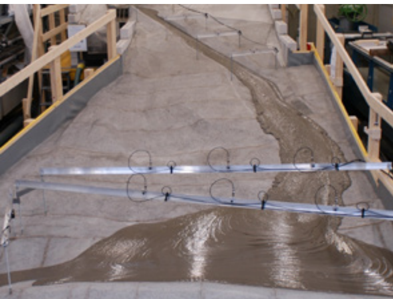
Abbildung 6: Murgangabfluss im Überleitkanal und Rückhalteraum beim Glyssibach-Modell. Auf der frei fließenden Strecke bilden sich Levées auf beiden Seiten des Murgangs. | Figure 6 : Ecoulement d'une lave torrentielle dans le canal de déversement et la zone de rétention dans le modèle de Glyssibach. Sur la section à écoulement libre, des levées se forment de part et d'autre de la lave torrentielle.
