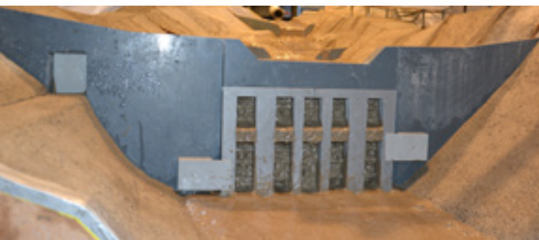
Abbildung 9: Abschlussbauwerk Roossi nach einem Versuch im Modell. Es erfolgte eine Verklauung der Öffnungen. Blick vom Unterwasser auf das Abschlussbauwerk. Figure 9 : Ouvrage de fermeture Roossi après un essai dans le modèle. Les ouvertures étaient bla-quées. Vue depuis l'aval vers l'ouvrage de fermeture.
