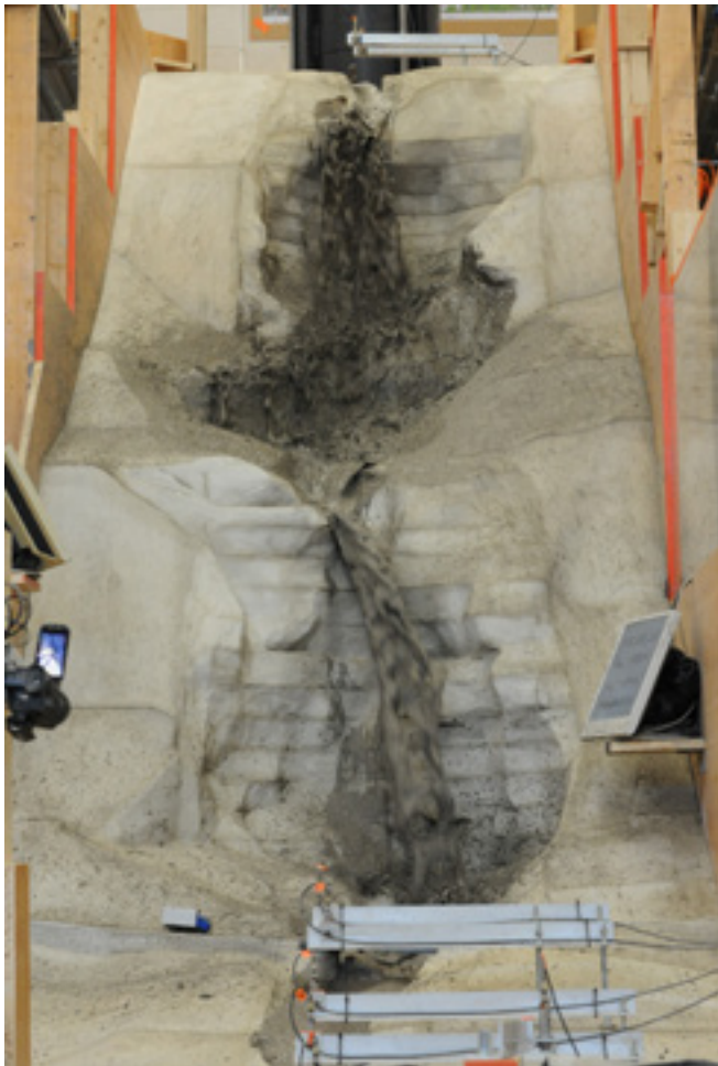
Abbildung 2b: Nachbildung eines Murgangereignisses im Fellbach-Modell. Die Messsensoren sind an Alu-Profilen über dem Gerinne montiert. Figure 2b : Reproduction d'un événement de lave torrentielle dans le modèle du Fellbach. Les capteurs sont montés sur des profil en aluminium au-dessus du lit.
