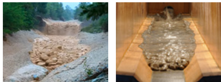
Abbildung 3: Links: Murgangereignis im Illgraben (WSL 2016). In der Front sind die grossen Blöcke gut ersichtlich. Rechts: Modellmurgang für die Illgraben-Untersuchung. Auch im Modellmurgang sind die grossen Blöcke in der Front vorhanden. Die Aufnahme stammt aus den Vorversuchen in einer geraden Rinne. Blick bei beiden Fotos gegen die Fliessrichtung. | Figure 3 : Gauche : Événement de lave torrentielle dans l'illgraben (WSL 2016). Les grands blocs sont clairement visibles à l'avant. Droite : Modèle de lave torrentielle pour l'examen de l'illgraben. Les grands blocs sont également présents à l'avant de la modélisation. La photo a été prise lors d'essais préliminaires dans un canal droit. Vue dans le sens contraire de l'écoulement pour les deux photos.
