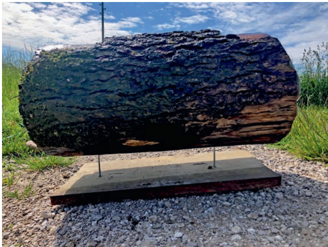
Abbildung 3: Befestigungsvorrichtung für die Holzstücke [Photo: Lukas Spycher]. Figure 3 : Dispositif de fixation des morceaux de bois [photo : Lukas Spycher].
