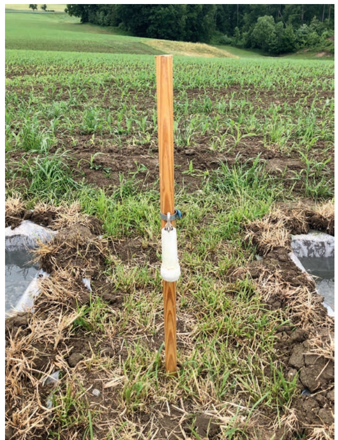
Abbildung 4: Montage der Datenlogger, links: für die Messung der Wassertemperatur in den wassergefüllten Becken, rechts für Messung der Lufttemperatur [Photo: Lukas Spycher]. Figure 4 : Montage des enregistreurs de données, à gauche : pour la mesure de la température de l'eau dans les bassins remplis d'eau, à droite pour la mesure de la température de l'air [photo : Lukas Spycher].
