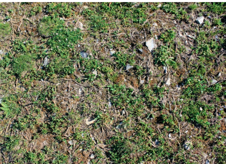
Abbildung 19: Nach 10 Jahren bereits weitestgehend zersetzte Kokosmatte im Versuchsgarten auf 2450 m ü.M. | Figure 19 : Dix ans plus tard, la natte de coco du jardin expérimental à 2'450 m d'altitude est déjà largement décomposée.
