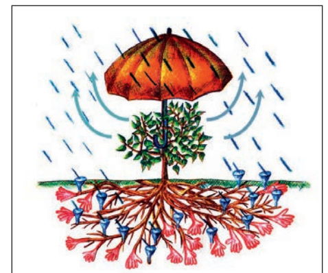
Abbildung 1: Boden stabilisierende Pflanzenfunktionen: Interzeption, Evapo-Transpiration, Wasserspeichervermögen, Wurzelwirkungen.
