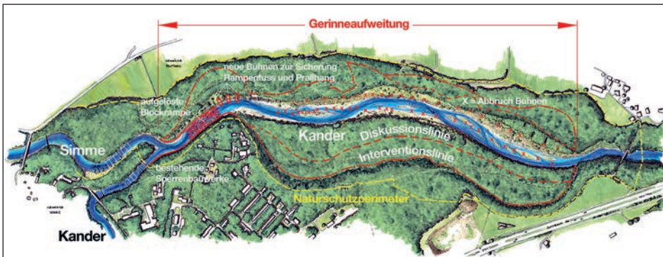
Abb. 3: Renaturierungs- und Wasserbauprojekt Augand 2004 mit den Massnahmen und den vorgesehenen Interventions- und Diskussionlinien, Quelle: Emch+Berger AG Fig. 3: Projet de renaturation et d'aménagement hydraulique en août 2004 avec les mesures, les lignes d'intervention et les discussions projetées, projetées, source: Emch+Berger AG
