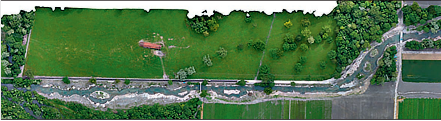
Abb. 6: Orthofoto des Projektperimeters nach der Projektumsetzung. Erkennbar ist neben dem neuen Gewässerlauf auch der verfüllte Abschnitt des ehemaligen Kanals (Quelle: A. Käppeli's Söhne AG, Sargans).
