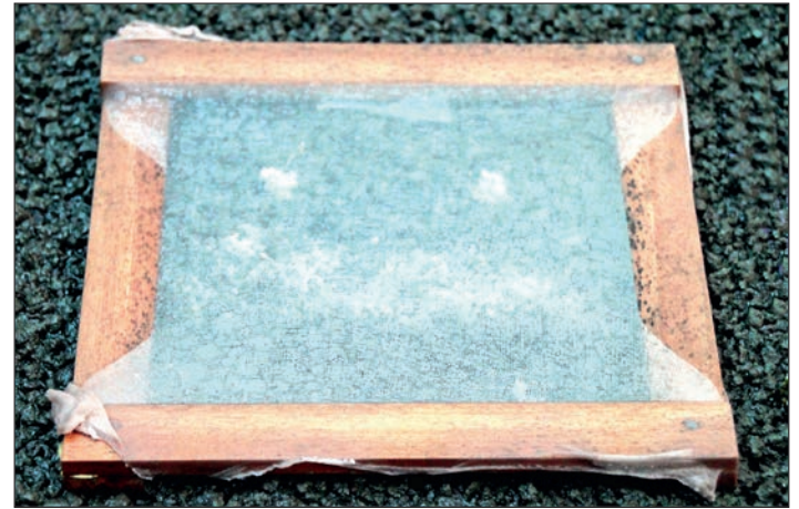
Abb. 8: Versuchsfläche mit Nylon-Abdeckung im Gewächshaus G in Birmensdorf ZH. Der Holzrahmen ist 15x15 cm gross.
