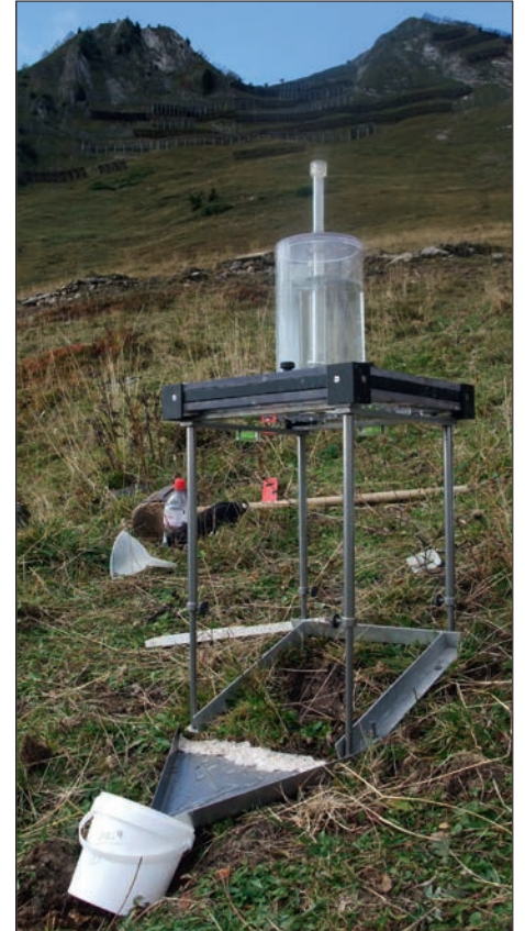
Abb. 2: Mit diesem Regensimulator von Eijkelkamp wurde eine Fläche von 25 cm x 25 cm mit insgesamt 1875 ml Wasser beregnet. Vorne am Simulator wurde ein Becher platziert der Abfluss und Abtrag während des Experimentes sammelt. Foto: R. Malin
