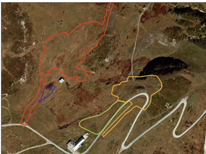
Abb. 4: Vor dem Bau. Orange: Pistenkorrektur Rominger. Grün: Materialzwischenlager. Blau: Umgesiedeltes Moor. Rot: Pistenkorrektur Reinalter mit Baustellenzufahrt (Luftbild: Geogrischa, vor 2013).
