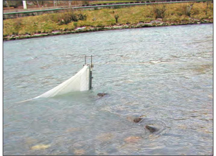
Bild 2: Driftversuche in der Aare im März / April 2008 (Limnex 2009). Links: Messung in unzugänglicher Kanalstrecke mittels Lastwagenkran, Tauchpumpe, Schläuchen, Netz und Bottich; rechts: Messung der Drift mit fixiertem Netz in der Kiesbankstrecke. Fotos Peter Baumann, Limnex AG.
