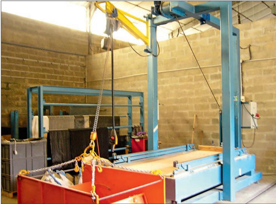
Fig. 12 : Dispositif d'essai plan incliné (IRSTEA).
