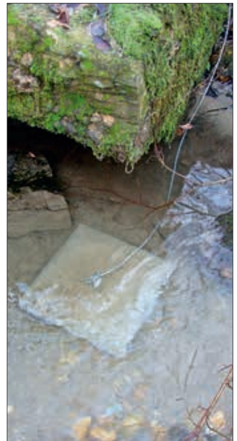
Abb. 3: Befestigung der Waschbetonplatte, auf der ein Wassertemperatursensor montiert ist, verbindet das Ufer mit einem Metallseil.
