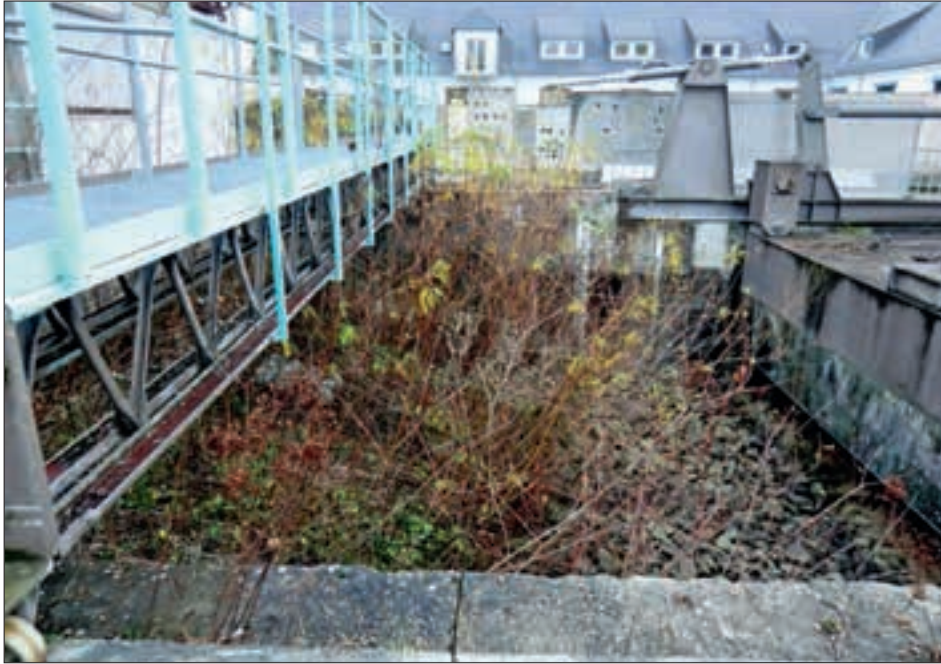
Abb. 5: Weidenspreitlage in Wellenbecken (BAW Karlsruhe, 28.11.2014).
