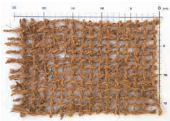
Abb. 1: Erosionsschutzgewebe aus Kokosfasern (ca. 700 g/m 2 ).
