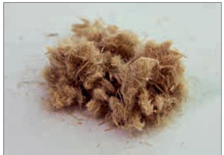
Abb. 2: Erosionsschutzfasern aus Cellulose für Hydrosaat.
