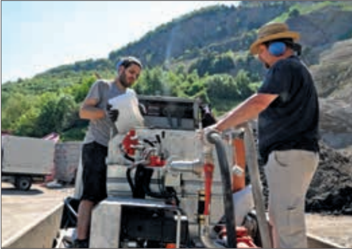
Abb. 3: Mischen der Komponenten im Hydroseeder. Fig. 3: Mélange des composants dans un hydroseeder.
