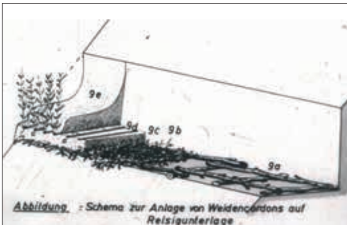
Abb. 3: Schematische Darstellung eines Weidencordons. Originalzeichnung von Praxl, 1957. Fig. 3: Représentation schématique d'un cordon de saule. Dessin original de Praxl, 1957.
