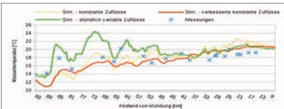
Abb. 6: Messungen der Wassertemperatur (x) und Simulationen der Wassertemperatur für verschiedene Zuflusseingabeparameter als Funktion des Abstands von der Mündung.
