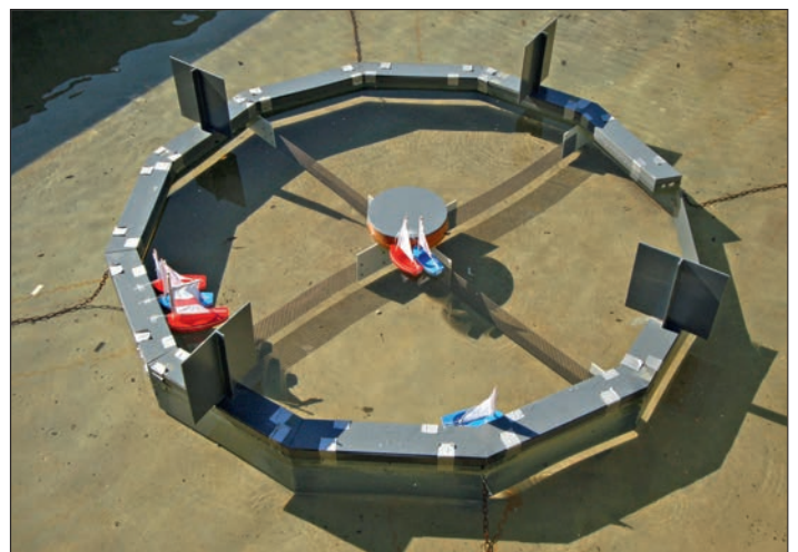
Figure 4: Maquette du port flottant à l'échelle 1:50. Les plaques «cibles» ont été fixées verticalement pour mesurer précisément les mouvements dus aux vagues (Morgane Ugo). Abbildung 4: Modell des schwimmenden Hafens im Massstab 1:50. Die «Ziel»-Platten wurden vertikal befestigt, um die Wellenbewegungen genau bestimmen zu können (Morgane Ugo).
