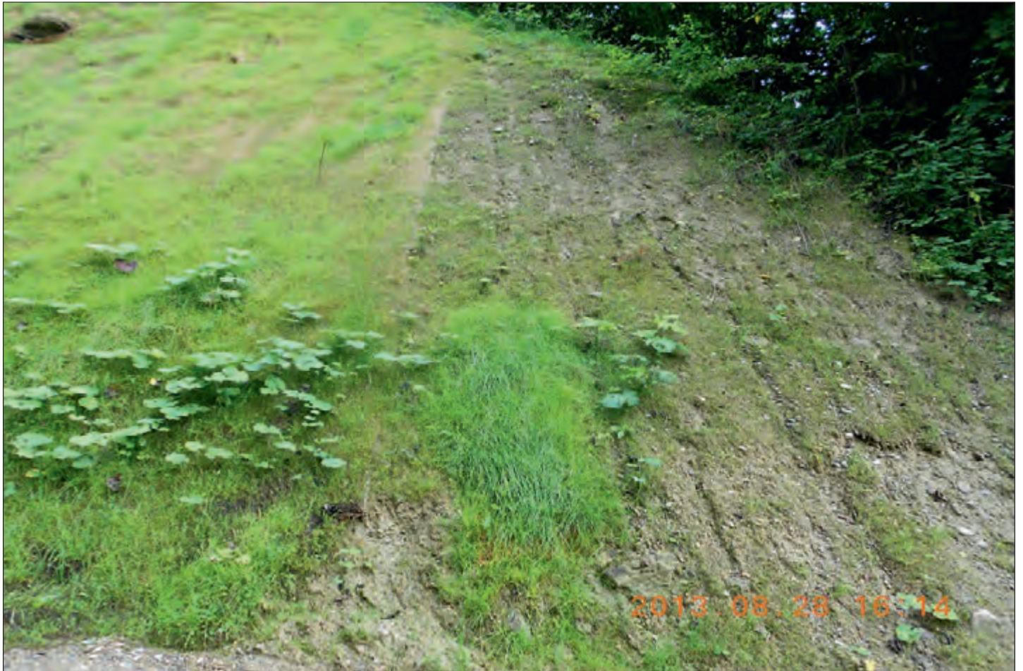
Abb. 36: Versuchsfläche (links) und Kontrollfläche (rechts). Die Vegetation auf der Versuchsfläche ist deutlich besser entwickelt. Bild Kurt Hollenstein Fig. 36: Parcelles expérimentales (à gauche) et parcelles de contrôle (à droite). La végétation sur la parcelle expérimentale est nettement plus développée. Image Kurt Hollenstein
