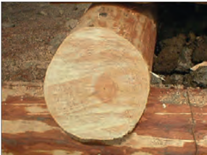
Abb. 3: Das Schwarzkiefernholz ( Pinus nigra ) ist für ingenieurbio­logische Massnahmen nicht geeignet: eine Schau­rainerwand im Versuchsgarten Wien Essling war nach 11 Jahren fast gänzlich vermorscht. Fig. 3: Le bois du pin noir ( Pinus nigra ) n'est pas approprié pour des mesures de génie biologique: un caisson en bois de démonstration dans le jardin d'essai de Vienne Essling était totalement vermoulu après 11 ans.
