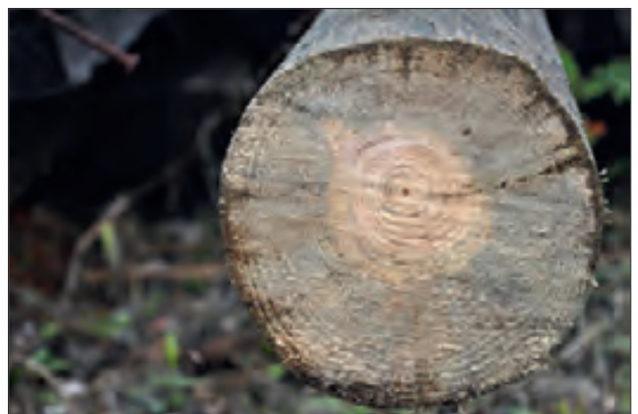
Abb. 2: C-K-F-imprägnierte Rotkiefernholz (Pinus sylvestris) halten im Erdbau noch länger als gute Lärchenhölzer.
