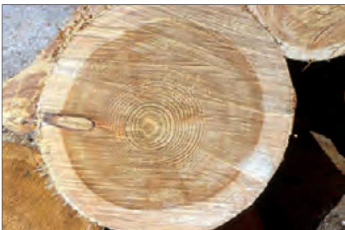
Abb. 1: Ein langsam gewachsenes Lärchen-Rundholz mit engen Jahresringen und dünnem Splint hält im Erdbau 15–25 Jahre lang. Die Qualität eines Lärchenholzes bedingt neben einer fachgerechten Bauweise entscheidend dessen Lebensdauer.
