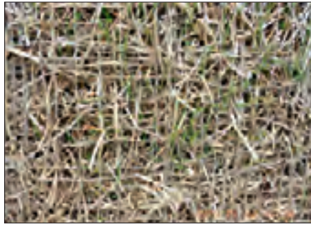
Abb. 15b: Vegetation einen Monat nach dem Einbau. Matte mit tiefer Grammatur, Bild Kurt Hollenstein
