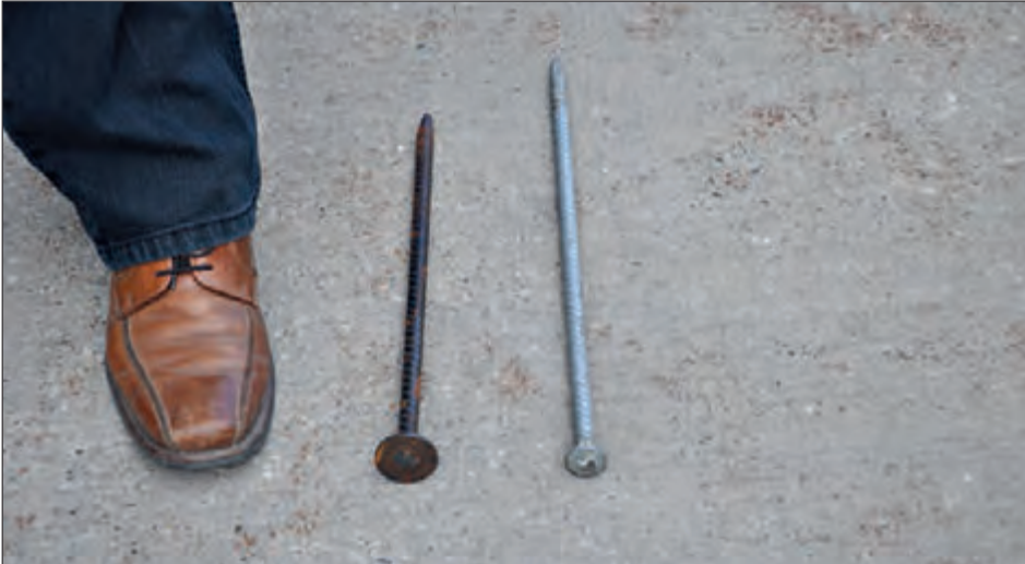
Abb. 7: Rostende Nägel lassen Eisenionen in das angrenzende Holz diffundieren, wodurch das Wachstum fäulnisregender Pilze gefördert wird. Verzinkte Nägel mit Köpfen verhindern das Rosten und Eindringen von Wasser entlang der Nägel.
