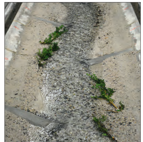
Abbildung 9: Verhältnisse im hydraulischen Modell bei einem Abfluss von 20 \text{ m}^3/\text{s} . Von den Raubäumen sind bei diesem relativ kleinen Abfluss lediglich die Wipfel im Wasser, die Wurzelstöcke ragen teilweise über den Wasserspiegel hinaus. (Blick in Fließrichtung.)
