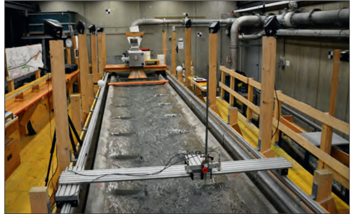
Abbildung 2: Hydraulisches Modell OptiFlux im Ist-Zustand, bei einem Abfluss von 240 m 3 /s (ca. HQ 30 ). Im Zuflussbereich steht eine Bandwaage zur Geschiebebeigabe. Zur Aufnahme der Sohle nach den Versuchen ist ein 3-D-Laserscanner am Kranträger aufgehängt. Im Vordergrund ist die Messschiene mit Echoloten und dem Stechpegel zu sehen. (Blick gegen die Fließrichtung.)
