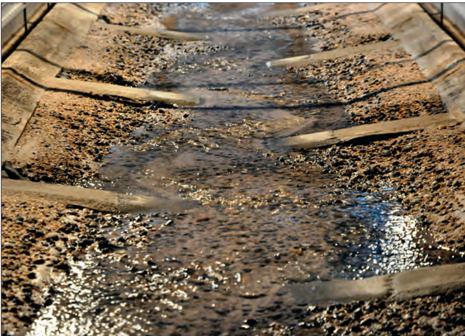
Abbildung 3: Hydraulisches Modell OptiFlux mit alternierenden, rechtwinkligen Bühnen, bei einem Abfluss von 5 m 3 /s, nachdem sich die Gerinneform bei einem Abfluss von 320 m 3 /s (ca. HQ 100 ) gebildet hat. Die bestehenden Bühnen wurden verlängert, sodass ihr Einfluss verstärkt werden konnte. Die pendelnde Hauptströmung ist deutlich zu sehen. (Blick in Fließrichtung.)
