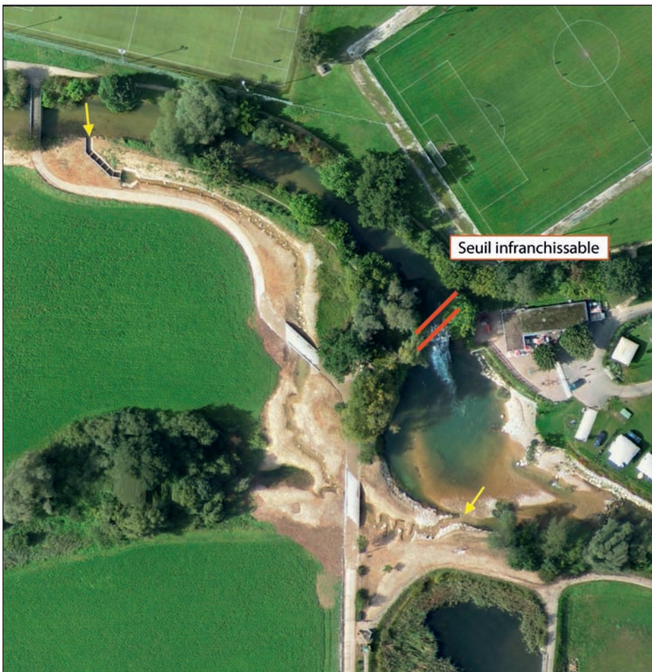
Fig. 9 : Vue aérienne du nouveau ruisseau de contournement et du seuil infranchissable. Les infrastructures existantes empêchent la réalisation de l'entrée de la passe au pied du seuil. Les flèches indiquent les extrémités de la passe (photo Easy2map – image géoréférencée prise avec un drone, sept. 2012). Abb. 9: Luftbild des neuen Umgehungsflusses und des unüberwindbaren Sockels. Die vorhandene Infrastruktur behindert die Einfügung des Fischpasses direkt in den unteren Sockelteil. Die Pfeile zeigen den Anfang und das Ende des Fischpasses an (Foto Easy2map – georeferenziertes Bild aufgenommen mit einer Drohne, Sept. 2012).
