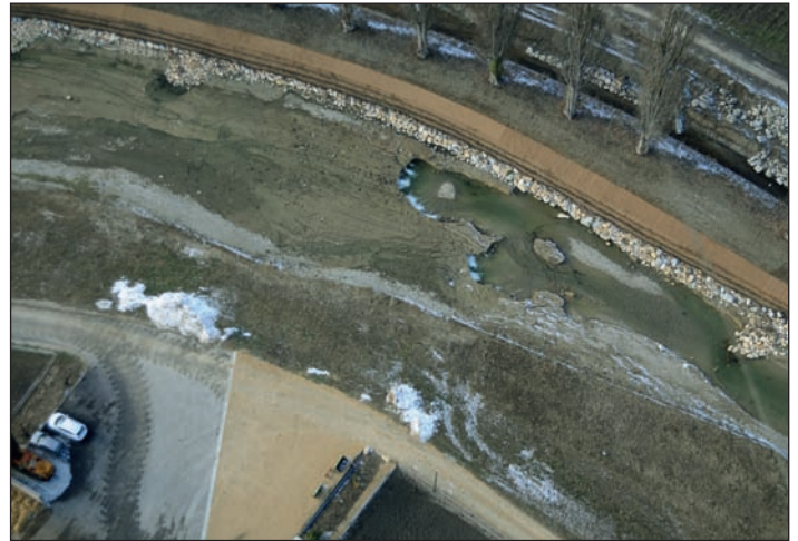
Fig. 7 : Au départ, un large lit plat a été terrassé (partie gauche de l'image), mais les différents types de matériaux du lit, les crues et quelques structures mises en place (épis, troncs, etc.) ont favorisé le développement d'un nouveau de lit de l'Aire très diversifié (partie droite de l'image). En haut, derrière l'alignement de peupliers, on devine l'ancien canal (photo Induni).
