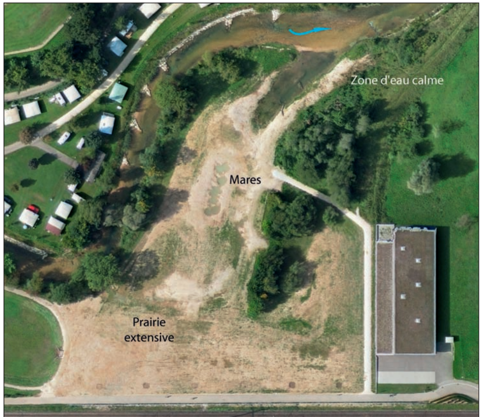
Fig. 5 : Dans ce secteur, anciennement cultivé de manière intensive, la terre végétale a été décapée et une prairie extensive accompagnée de quelques bosquets a été mise en place. Pour augmenter la diversité des milieux, des mares et une importante zone d'eau calme liée à la Sorne ont été créées (photo Easy2map – image géoréférencée prise avec un drone, sept. 2012).
