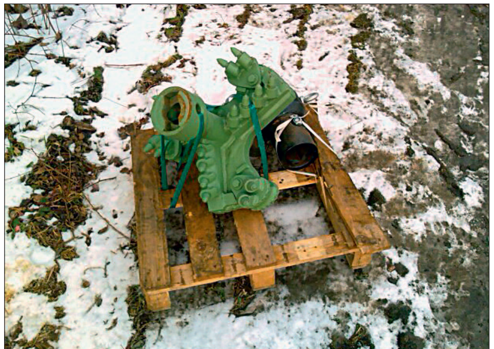
Abb.3: Angelieferter Bohrkopf für den Pressbohrvortrieb, Durchmesser 600 mm (Bild: Tiefbauamt des Kantons Zug).
